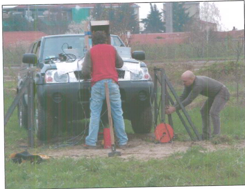
Foto 3: Energizzazione delle onde di taglio mediante apposita struttura.
